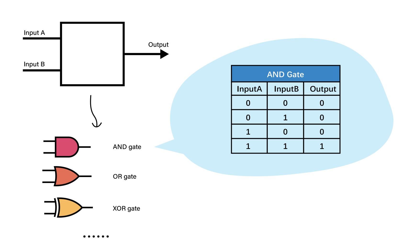
首先我们尝试解释逻辑门的概念。逻辑门是数字电路的基本构建块。大多数逻辑门有两个输入和一个输出。在任何给定时刻,每个终端处于两个二进制条件之一,低(0)或高(1),由不同的电压电平表示。
