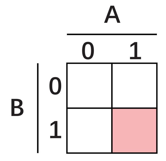
与门,又称"与电路"、逻辑"与"电路。是执行"与"运算的基本逻辑门电路。有两个输入端,一个输出端。当所有的输入同时为高电平(逻辑1)时,输出才为高电平,否则输出为低电平(逻辑0)。
