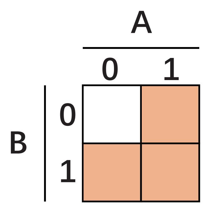
或门,又称"或电路"。如果几个条件中,只要有一个条件得到满足,某事件就会发生,这种关系叫做"或"逻辑关系。或门有两个输入端,一个输出端,只要输入中有一个为高电平时(逻辑"1"),输出就为高电平(逻辑"1");只有当所有的输入全为低电平(逻辑"0")时,输出才为低电平(逻辑"0")。
