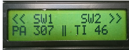
Figur 34: SW2 = næste position, SW1 = forrige position. Nederst vises den aktuelle position
