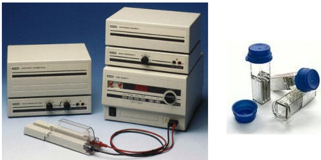
Abb. 4: Elektroporationsanlage BioRad Gene Pulser II (links), Elektroporationsküvetten (rechts)
